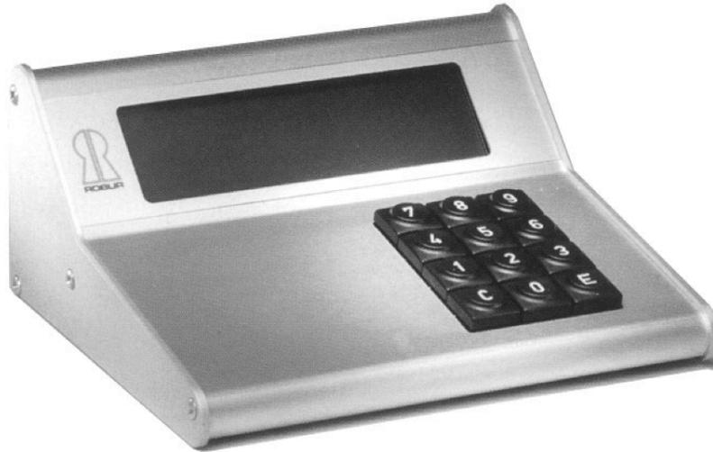
**Система RS 4000.** Сотрудник банка активирует электронный замок конкретной депозитной ячейки на панели управления. Только после этого клиент может открыть свою ячейку своим персональным ключом ASSA. Ячейка находится под постоянным наблюдением. Все действия регистрируются на центральном устройстве.
